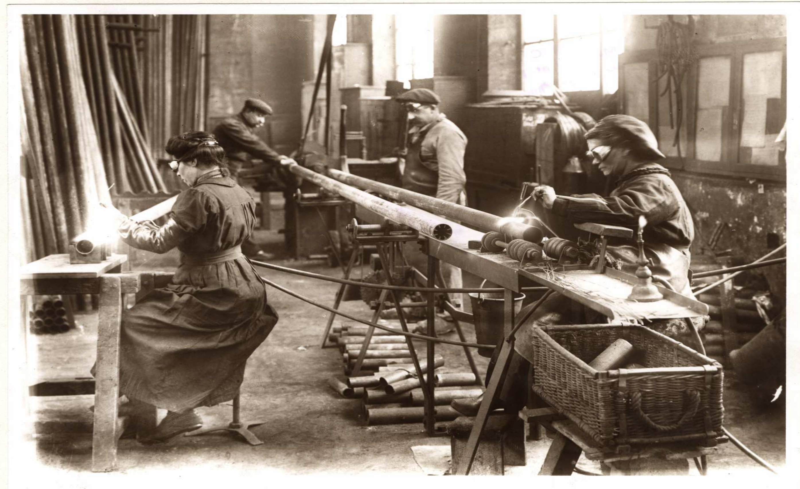
ATELIER DE PARIS CHAUDRONNERIE DE CUIVRE. Soudage des tubes à fumée
